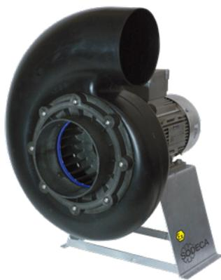
Mitteldruck-Radial-Abzugsventilatoren, einseitig ansaugend, aus antistatischem ATEX-Kunststoff. ATEX 2G- oder 2D-Zertifizierung mit Motor druckfest Ex db, erhöhter Sicherheit Ex eb oder Schutz durch Gehäuse Ex tb für den Betrieb in gas- oder staubexplosionsgefährdeten Bereichen.
