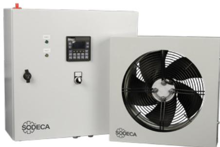
Die PRESSKIT-Anlagen bestehen aus einem oder mehreren Ventilatoren. Diese laufen im Brandfall an, um in den geschützten Bereichen einen Überdruck von 50 Pa zu erzeugen und das Eindringen von Rauch in die Evakuierungswegen zur Evakuierung zu verhindern.
